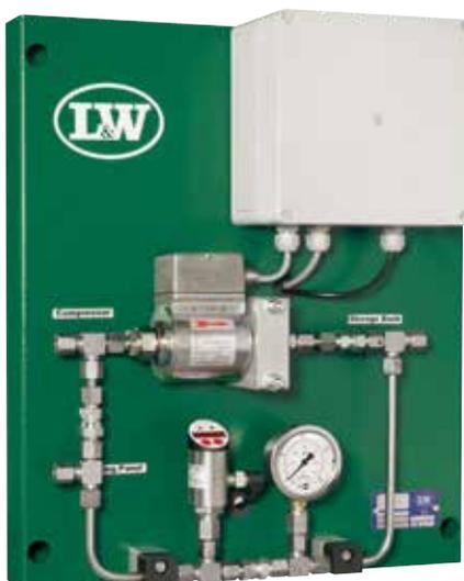
Durch den elektronischen Druckaufnehmer können die Schaltpunkte genau eingestellt werden. Diese Anlage ist zu verwenden wenn der Fülldruck nahe am Vorratsdruck des Speichers liegt z.B. Speicherdruck 330 bar und Fülldruck 320 bar.
