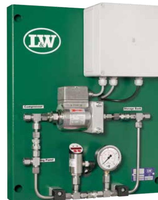
Durch den elektronischen Druckaufnehmer können die Schaltpunkte genau eingestellt werden. Diese Anlage ist zu verwenden wenn der Fülldruck nahe am Vorratsdruck des Speichers liegt z.B. Speicherdruck 330 bar und Fülldruck 320 bar.
