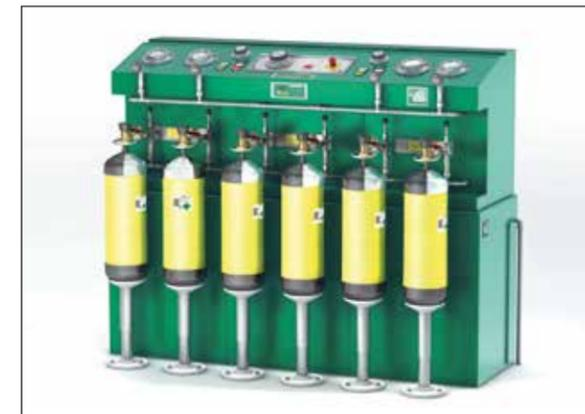
Schnelladapter zum Füllen von Atemluftflaschen in der Atemschutzwerkstatt von Feuerwehren für den direkten Anschluss an vorhandene Fülleisten (nur mit Gewichts- und Höhenausgleich verwendbar).
